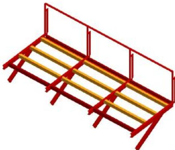
Como puede observarse, se han modelizado también las barras de soporte de la barandilla, puesto que sobre ellas actúa la carga horizontal que marca el Art. 3.2 del DB-SE Acciones en la edificación. Con ello, además de verificar el dimensionado de la propia barandilla se generan las correspondientes acciones sobre el resto de la estructura.
