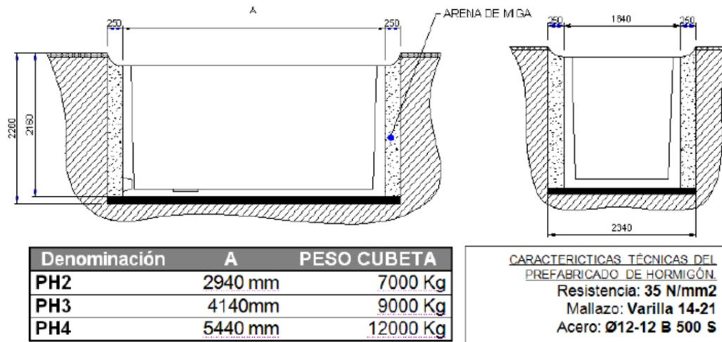
Figura 13 Dimensiones arqueta de hormigón
